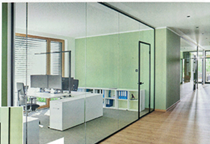
Das trockenverglaste Trennwandsystem AL-Office von Längle Glas zeichnet sich durch eine große Gestaltungsvielfalt, das klare Design und den geprüften Schallschutz aus.
